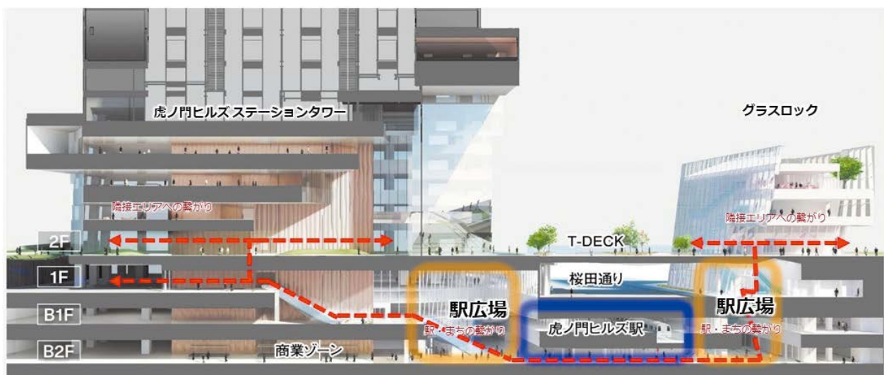
再開発ビルと接続された駅の断面（イメージ図）
