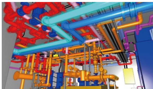
作成した大温室設備の3D-CADデータ
